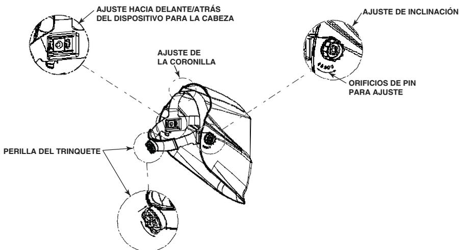
**Ajuste al Tamaño de la Cabeza:** La tensión del dispositivo para la cabeza se ajusta oprimiendo la perilla del trinquete y girando para ajustar al nivel de comodidad deseado. Esta perilla se localiza en la parte posterior de la careta. El **AJUSTE DE LA CORONILLA DEL DISPOSITIVO PARA LA CABEZA** se logra adaptando la cinta de la coronilla para colocación vertical sobre la cabeza e introduciendo el pin en el orificio para asegurar en su lugar.
