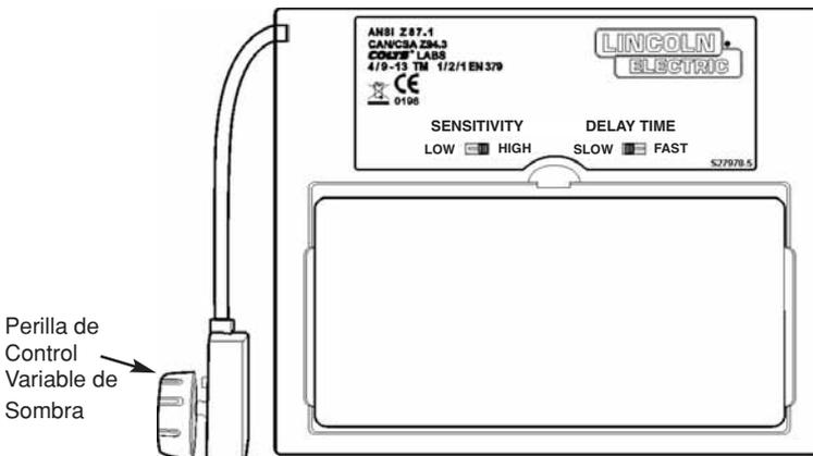
**SIEMPRE PRUEBE PARA ASEGURARSE DE QUE EL CARTUCHO ADF ESTÁ CARGADO ANTES DE SOLDAR.** El cartucho puede colocarse a la luz del sol para cargarlo. No almacene la careta en un gabinete oscuro u otra área de almacenamiento por periodos prolongados. Mientras suelda, el arco también carga al cartucho ADF.
