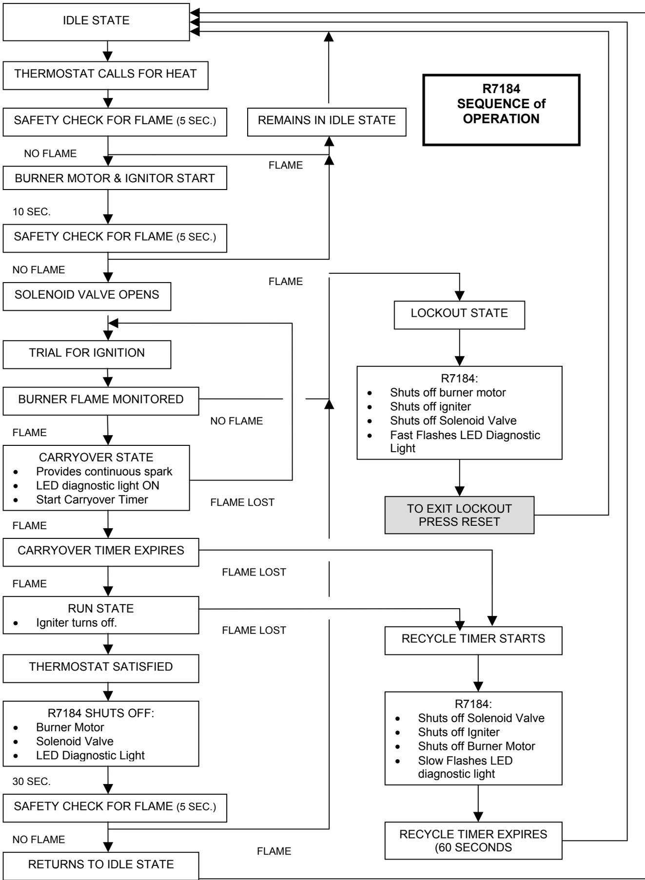
**Table C-1: ELECTRONIC FAN TIMER BOARD (EFT) DETAILED SEQUENCE OF OPERATION**
