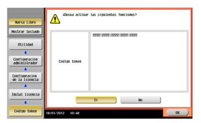
Esta máquina establece comunicación con License Management Server (LMS) y activa la función avanzada gestionada por el número de testigo. Una vez realizados correctamente el registro de la licencia y la activación de la función avanzada, la máquina se reinicia automáticamente.
