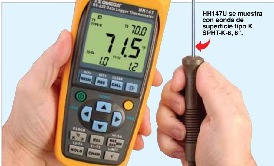
HH147U se muestra con sonda de superficie tipo K SPHT-K-6, 6".
