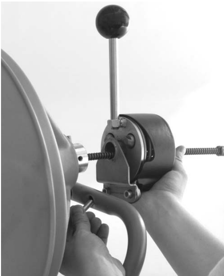
Figure 3 – Montage du système d'avancement automatique sur le châssis
