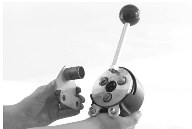
Figure 2 – Installation du support sur le système d'avancement automatique
