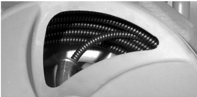
Figura 9 – Enrolle el cable en el tambor tal como se muestra.
