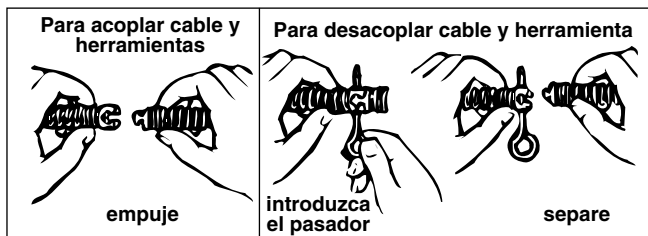
Figura 5 – Acoplamiento y desacoplamiento de las herramientas
