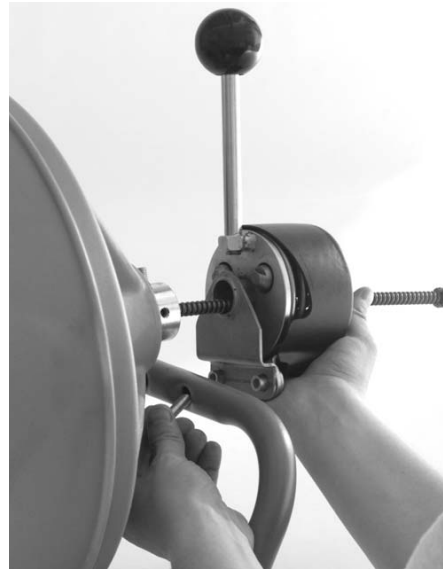
Figura 3 – Montaje del auto-alimentador en el armazón de la máquina
