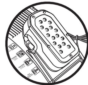
**NOTA:** Los paquetes de pilas de 9,6 V, 12 V, y de 14,4 V no entran completamente en el receptáculo del cargador. Introduzca los paquetes de pilas de 9,6 V, 12 V, y de 14,4 Volts hasta que entren a presión en su lugar y queden alineados con la línea del cargador, como se muestra a la izquierda.
