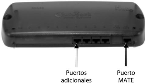
Cuando un HUB ocupa el puerto MATE/HUB del inversor, la pantalla del sistema se conecta directamente al HUB. (Si la pantalla del sistema es un MATE, no la conecte durante el arranque inicial. Si desea más información, consulte el *Manual del operador*.)
