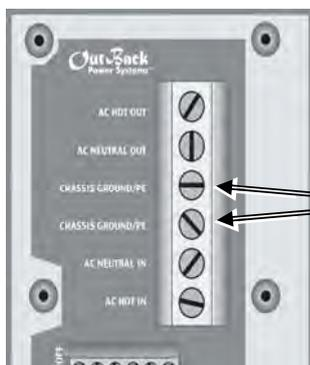
Los dos terminales de puesta a tierra/PE de la carcasa son comunes eléctricamente. En caso de conexión a una barra de puesta a tierra externa, se necesita usar un solo terminal. El otro terminal puede usarse si se conecta a un dispositivo con su propio cable de tierra, como un generador.
