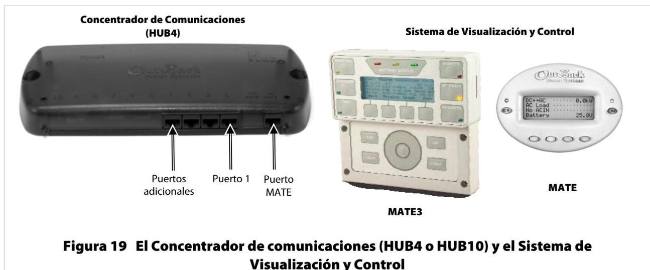
**Figura 19 El Concentrador de comunicaciones (HUB4 o HUB10) y el Sistema de Visualización y Control**
