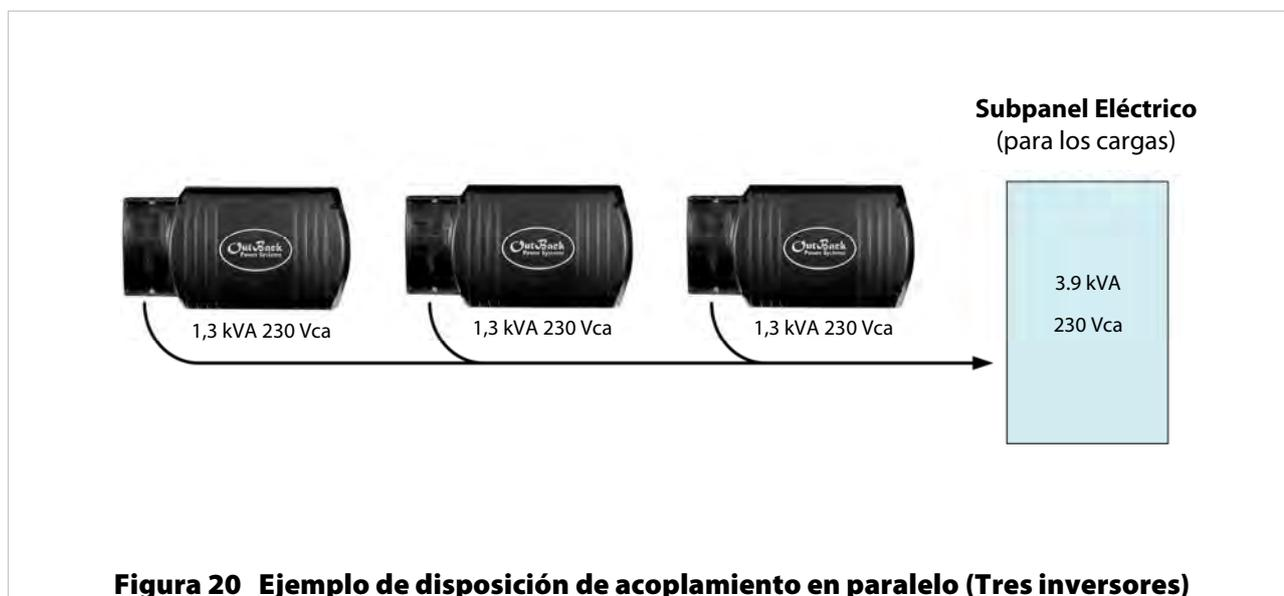
**Figura 20 Ejemplo de disposición de acoplamiento en paralelo (Tres inversores)**
