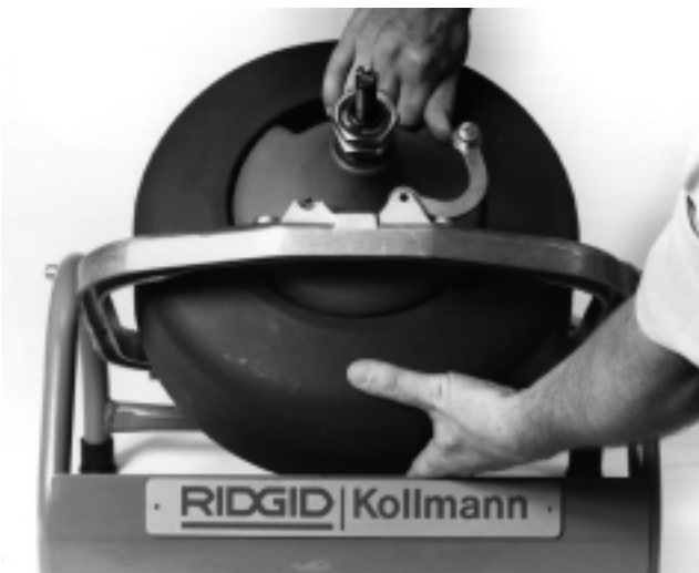
Figura 2 – Alineamiento del tambor con la perforación en la caja de velocidades.
