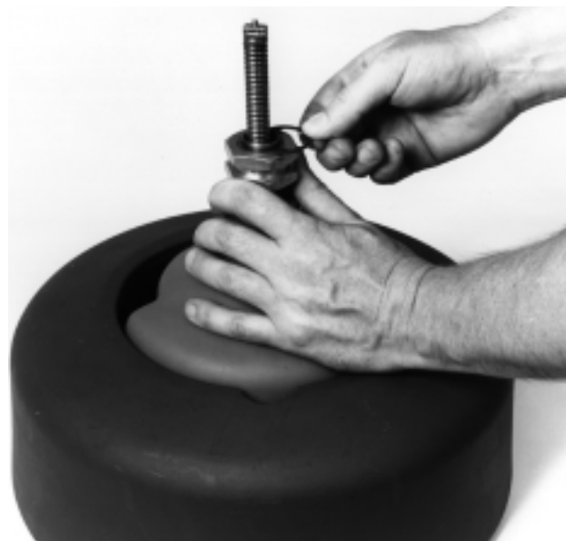
Figure 13 – Remontage du tambour interne, du support avant et des cerclips.
