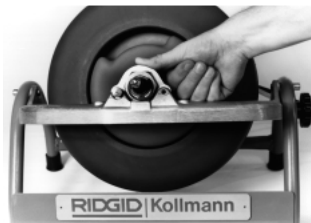
Figure 3 – Verrouillage de la bride avant
