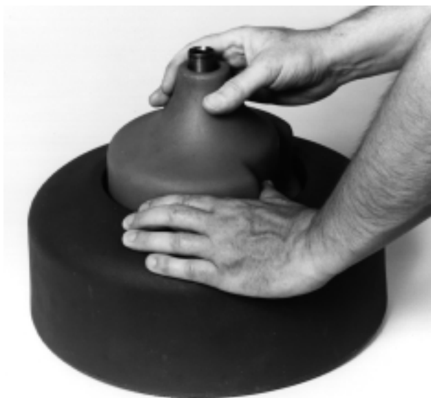
Figura 11A – Extracción del tambor interior.
