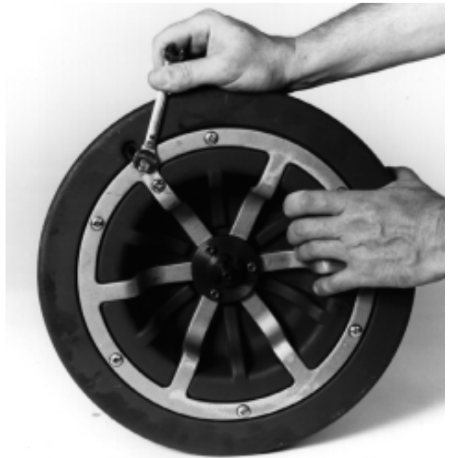
Figura 9 – Soltando la brida para el cable.
