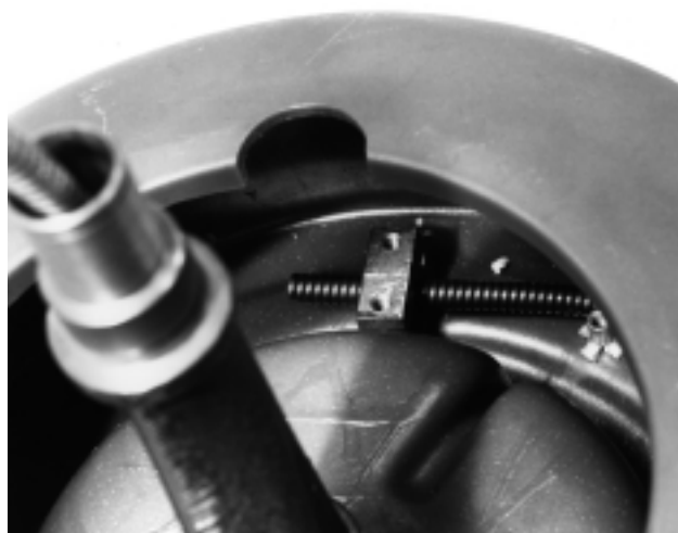
Figura 12 – Coloque el nuevo cable debajo de la brida.
