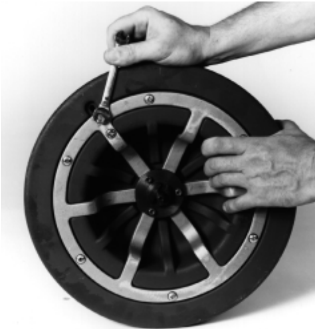
Figure 9 – Desserrage du support de câble
