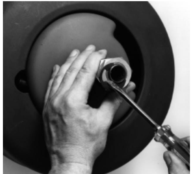
Figure 11 – Dépose des cerclips
