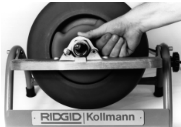
Figura 3 – Enclavamiento de la brida delantera.
