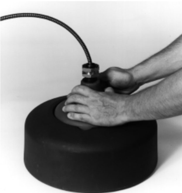
Figure 10 – Retrait de l'extrémité du câble
