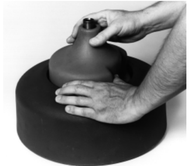
Figure 11A - Dépose du tambour interne
