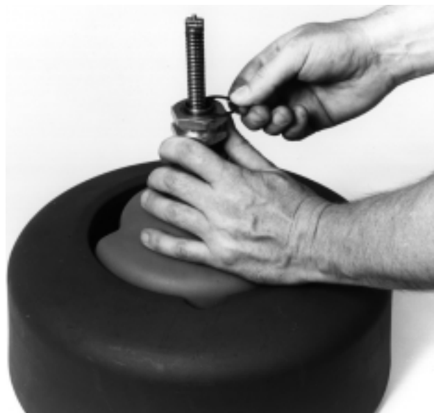
Figura 13 – Ensamblaje del tambor interior, de la brida delantera y de los clips en "E".
