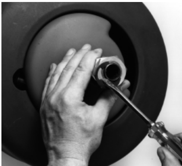
Figura 11 – Extracción de los clips en "E".
