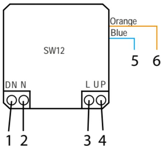
Para poder instalar el SW12 se necesitan un cable neutro y un cable fase al punto de instalación.
