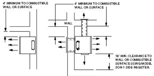
CLEARANCE FOR SIDE OUTLET KITS AND REAR REGISTER
