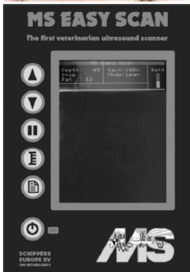
Figura H: Medición de grasa en pantalla digital
