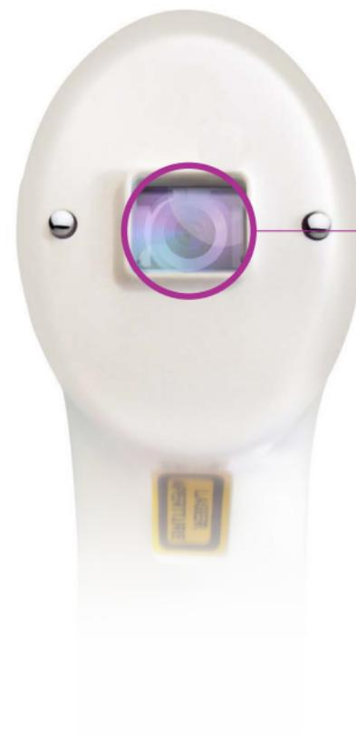
Compruebe periódicamente que no haya ningún depósito de humo en la abertura del láser. La acumulación de depósitos afectará la eficacia del láser. Si observa algún depósito. APAGUE la unidad y desenchufe el adaptador de corriente. Límpiela con un paño sin pelusa o bastoncillo de algodón.
