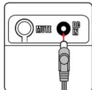
1. Enchufe el adaptador de corriente a la toma de corriente en la parte de atrás de la unidad y luego enchúfelo a la fuente de electricidad.
