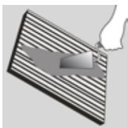
No es recomendable aplicar el adhesivo en grandes superficies, para evitar así el efecto piel (tiempo abierto sobrepasado). Solo se colocará el adhesivo necesario según el avance y/o rendimiento del aplicador.
