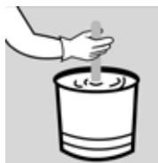
Amasar el adhesivo con la cantidad de agua indicada, en un recipiente limpio y estanco, nunca en el piso. Use batea o carretilla. Si es posible, usar mezclador mecánico hasta obtener una mezcla homogénea y dócil.
