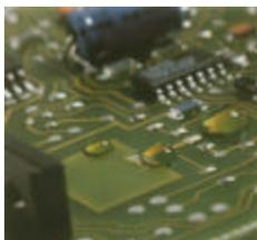
La película formada por el Recubrimiento Novec<sup>MR</sup> Electronic Coating produce una baja energía superficial en el sólido, dando repelencia a aceites hidrocarbonatos, aceites de silicón, fluidos sintéticos y soluciones acuosas.
