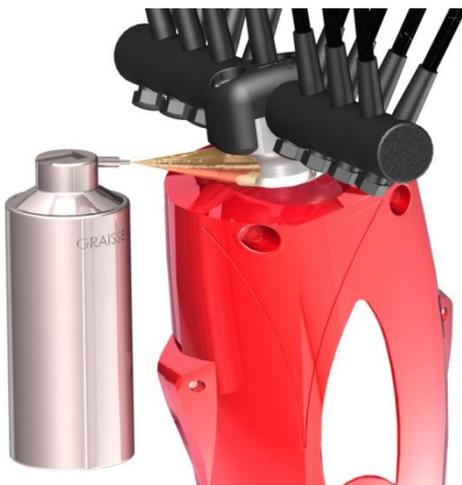
Posicionar la boquilla del aerosol hacia la rótula. Mantener el aerosol a la vertical y pulsar. Engrasar al mínimo una vez al día la cabeza de vibración (este engrase se efectúa sin desmontar nada).
