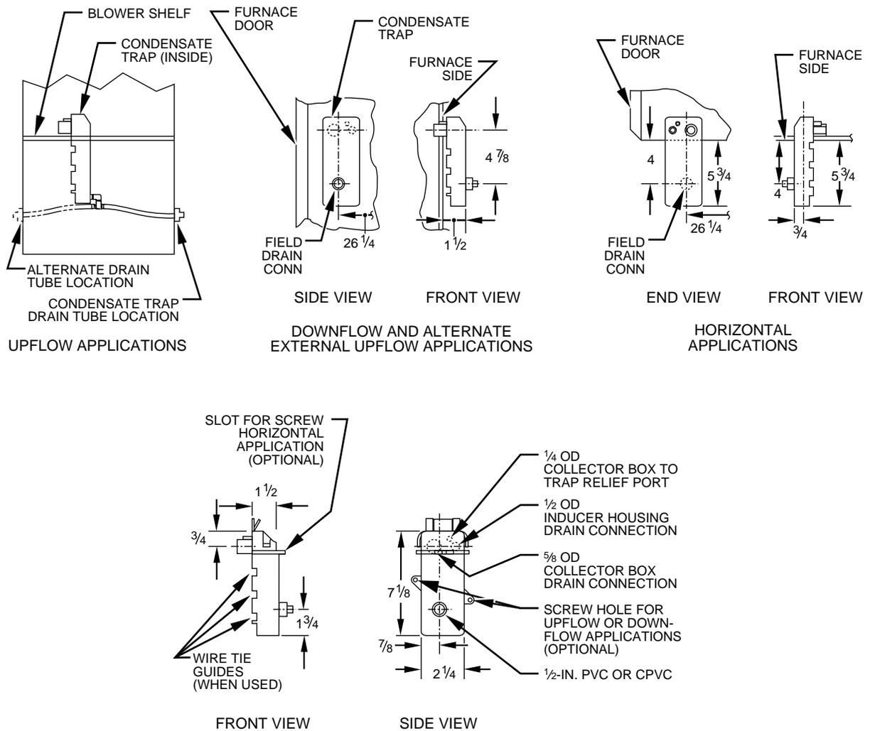
**Fig. 4—Condensate Trap**
