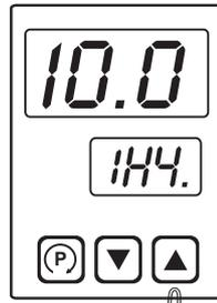
Indicación máxima de corriente para el transformador.
