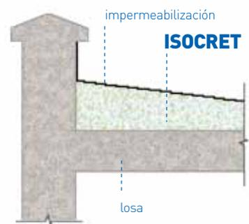
No necesita juntas de dilatación, no se retrae ni agrieta tanto para azoteas transitables o no.
