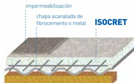
Aislante térmico de cubiertas industriales. Optimo para aplicación de aislante hidrófugo.
