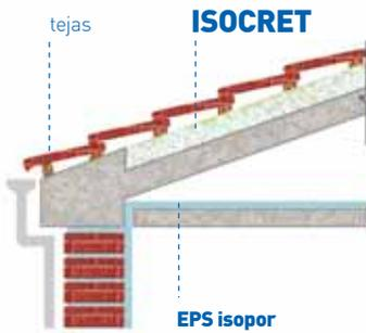
Su controlada consistencia facilita la realización de pendientes en cubiertas inclinadas sin deslizamiento del material.
