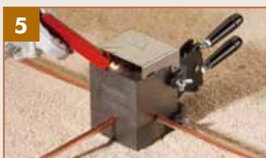
5 Encender aplicando el chisquero de piedras sobre el polvo iniciador extendido en el borde del molde.
