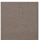
Humedecer la primera capa y aplicar una segunda capa con la misma consistencia que la primera, en sentido cruzado a la anterior, creando una trama. Puede terminarse con fratazo o llana metálica. Es revestible con pinturas, revoques y/o cerámicos.
