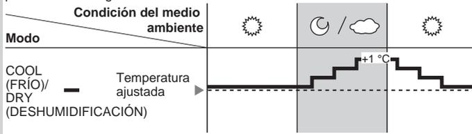
Activada la función ECONAVI, la unidad mantiene la temperatura ajustada hasta que se detecta una elevada intensidad de luz solar. El sensor de luz solar detecta la intensidad de la luz solar durante cambios de tiempo o de día/noche, y la unidad ajusta la temperatura.
