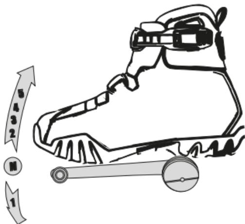
La AK 125/150 TTR viene equipada con una caja de cambios de 5 velocidades que opera según la gráfica, la palanca de cambios se encuentra ubicada al lado izquierdo del motor. Para accionar los cambios de manera apropiada, se debe accionar al mismo tiempo el clutch y desacelerar. Cada vez que se seleccione
