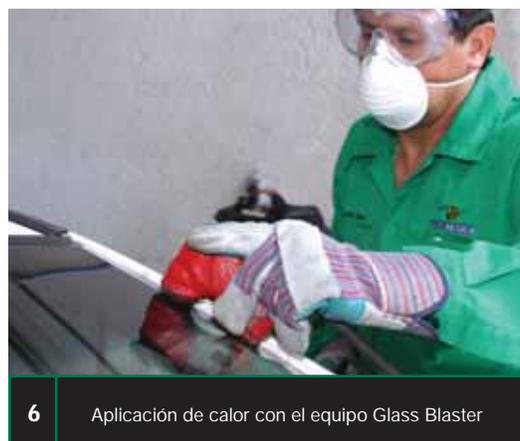
6 Aplicación de calor con el equipo Glass Blaster
