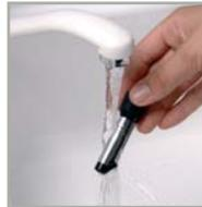
La boquilla de vapor se desmonta para permitir una limpieza a fondo. Lávela con agua y un poco de detergente para vajillas no abrasivo con un pequeño cepillo. Aclárela y séquela. Antes de volver a ponerla en su sitio, asegúrese de que los orificios de entrada de aire no están obstruidos y no hay restos de leche. Desatásquelos con una aguja si fuera necesario.
