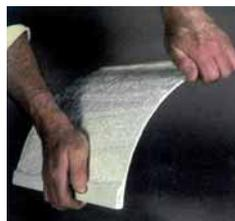
El espesor medio de las piezas acabadas rondará los 5 mm y las piezas se pueden desmoldar dos horas después de empezar el proceso.
