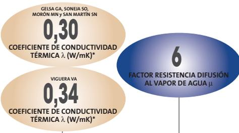
\* Determinación de la conductividad térmica según las pautas definidas en la UNE-EN-13.279-1: 2006, correspondiente a material seco aplicado en interiores. (23°C y 50% de humedad relativa). Valor para el cálculo de parámetros característicos y particiones interiores según el CTE-DB HE-1.
