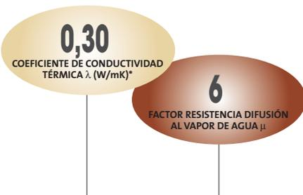
\* Determinación de la conductividad térmica según las pautas definidas en la EN-12.524. Los valores de referencia corresponden al material en seco utilizado en el adhesivo. Valor para el cálculo de parámetros característicos y particiones interiores según el CTE-DB HE-1.
