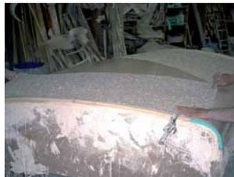
5. Sobre el MAT se aplica una siguiente capa de la mezcla más fluida asegurando que queda bien impregnado y existe una buena adherencia entre las diferentes capas.
