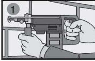
Realizar el agujero de diámetro y profundidad requeridos con un taladro roto-percutor. El diámetro del orificio debe ser entre 1/8 y 1/4 de pulgada mayor al diámetro de la barra a anclar.
