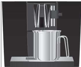
▶ Coloque un recipiente debajo del vaporizador de espuma fina y otro debajo de la salida de café.
