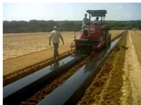
Maquinaria diseñada para la aplicación e incorporación de Basamid conformando los lomos en un solo pase.
