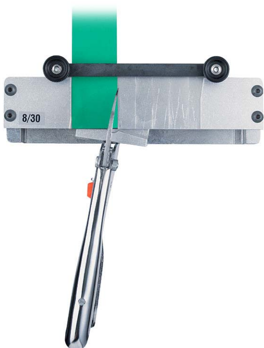
Ilustración 1: Corte del primer extremo de la banda/correa
