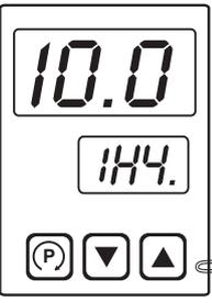
Indicación máxima de corriente para el transformador.
