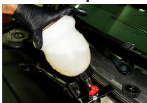
Colocar el depósito de relleno
