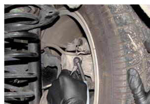
Conectar el sangrador al freno, ponerlo en marcha y aflojar el racor de purga del freno para aspirar líquido
