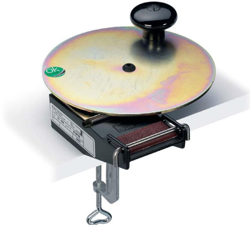
El AT-60 es un dispositivo de preparación para el biselado de bandas y cintas Habasit de hasta 60 mm / 2.4 *pulg.* de ancho y un grosor de 2 mm / 0.08 *pulg.*. La banda se fija y adhiere a la plancha de acero y se rectifica manualmente utilizando un disco abrasivo. Es posible ajustar el grosor de la banda en dos etapas.
