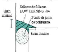
Figura 2: Junta de lengüeta postiza
