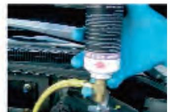
Atornille y desatornille la palometa sobre el aditivo para perforar el bote y con él en posición invertida espere a que se introduzca.
