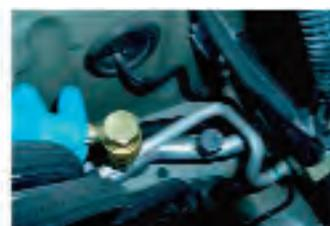
Conecte la manguera al racor de baja presión del sistema de A/C.
