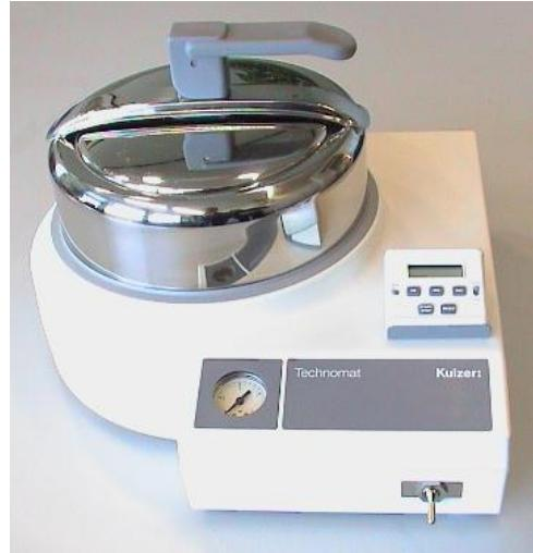
La configuración de aparato adecuada a su función, posibilita el manejo sencillo del mismo. Cuando la palanca de la valvula se mueve hacia arriba, la presión aumenta hasta el nivel de 2,0 bar. El manómetro de presión dentro de la carcasa indica la presión real de trabajo. La presión es liberada al mover la palanca de la valvula hacia abajo. El Technomat es un aparato compacto económico en espacio. La carcasa consta de partes fabricadas de macrolon y el recipiente de presión es de acero INOX.
