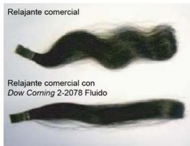
**Figura 3: pelos tratados (acondicionador enjuague) con Dow Corning® 2-2078 Fluido muestra mayor trabajo comparada al producto no tratado, con una confiabilidad estadística del 99% (Trabajo es la carga total o fuerza necesaria para alargar el pelo multiplicada por el desplazamiento).**
