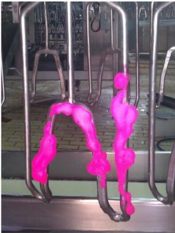
Aplicación de TBF 300 tras la limpieza y desinfección
