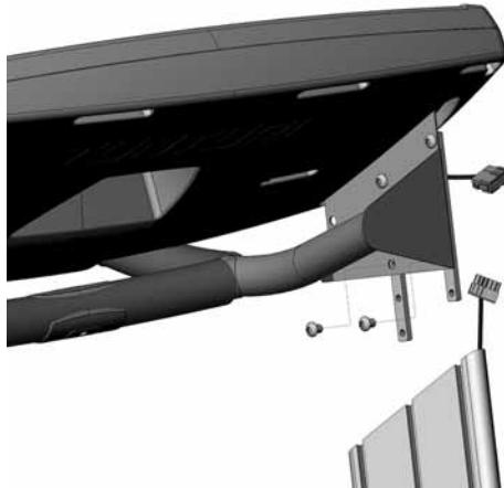
Halten Sie die seitlich an den Handstützen befindlichen Verbindungsstücke so nach unten, dass Sie jedes Verbindungsstück mit der Befestigungsschraube (**F**) durch die unteren Verbindungslocher der Handstütze befestigen können. Schrauben Sie in dieser Arbeitsphase die Verbindungsstücke möglichst lose fest. Bitte die Schrauben an den Verbindungsteilen nicht entfernen.
