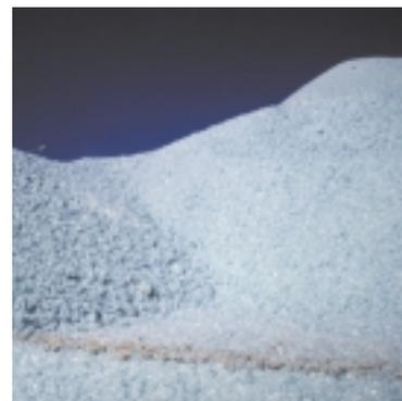
Vidrio reciclado proveniente del propio proceso de fabricación
