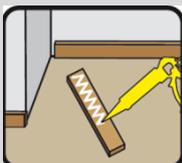
**weber glue MS55** se suministra listo al uso y se debe insertar en una pistola para poder ser aplicado (mediante extrusión) de una manera sencilla.
