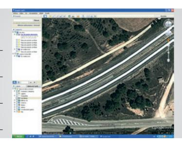
Settop Eje de regresión es un software capaz de analizar mediante ingeniería inversa cualquier eje para el estudio de trazado de carreteras y ferrocarriles existentes. Gracias a un potente algoritmo de cálculo, Settop Eje de regresión realizará el análisis, sin límite de kilometraje, de cualquier vía obteniendo resultados sólo comparables al trabajo de un especialista de trazado.
