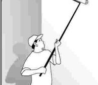
Revolver el producto en su envase, antes de la aplicación. Adibond, se aplica con brocha o rodillo en forma homogénea. No debe haber exceso de producto por escurrimiento. Definir rendimiento en obra. (En Datos Técnicos se define un rendimiento en base a su aplicación con rodillo)
