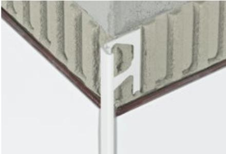
Schlüter®-JOLLY-P (PVC de color) está fabricado en PVC duro de color, por lo que no se puede doblar, ni rayar. El material está estabilizado a los rayos UVA, pero no está resistente a los cambios de color en exteriores. No es apto para la protección de cantos o como remate en zonas con altas agresiones mecánicas, como, p.e., en escaleras y entregas en pavimentos.
