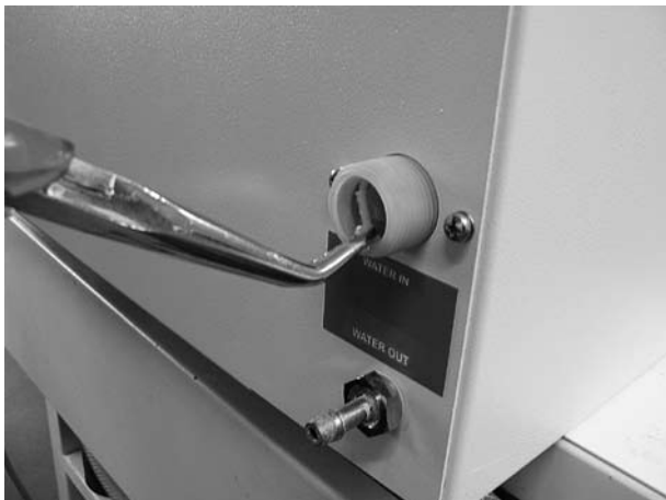
Fig. 5: Einbaulage des Wasserfilters am Frischwasseranschluss
