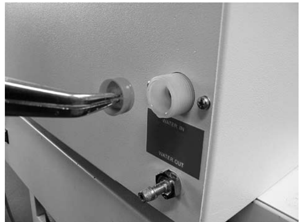
Fig. 5: Situación de montaje del filtro del agua a la conexión de agua fresca
