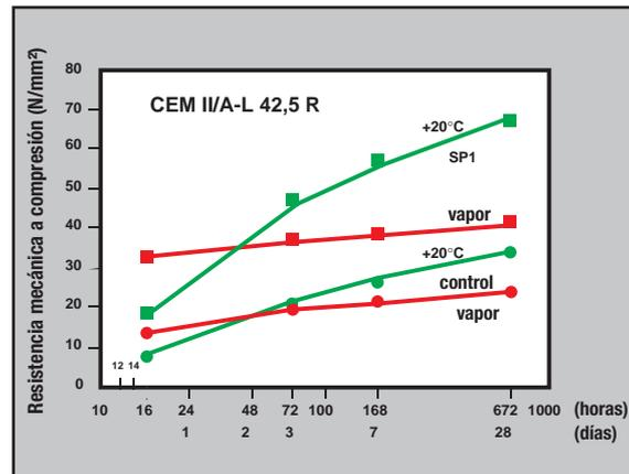
Figura 2 - Resistencia mecánica a compresión en función del tiempo, de hormigones preparados con Dynamon SP1 y CEM I 42,5R
