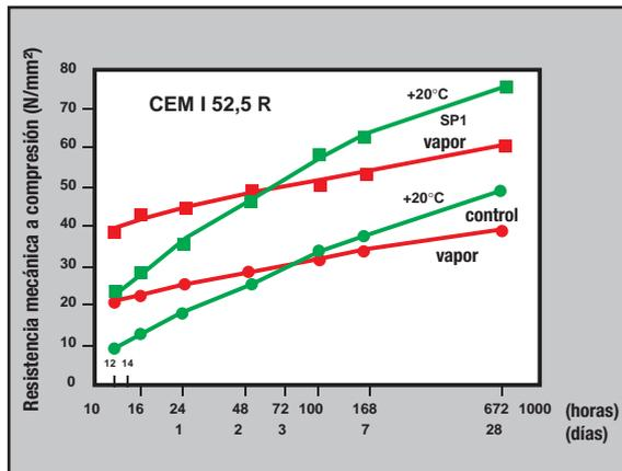
Figura 1 - Resistencia mecánica a compresión en función del tiempo, de hormigones preparados con Dynamon SP1 y CEM I 52,5R
