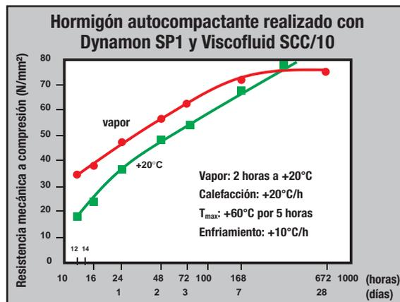
Figura 3 - Resistencia mecánica a compresión en función del tiempo, de hormigones preparados con Dynamon SP1 y Viscofluid SCC/10
