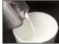
**A)** Vierta el contenido de la garrafa (componente B) en un recipiente limpio y añada el contenido del saco de polvo (parte A), agitando la mezcla.
