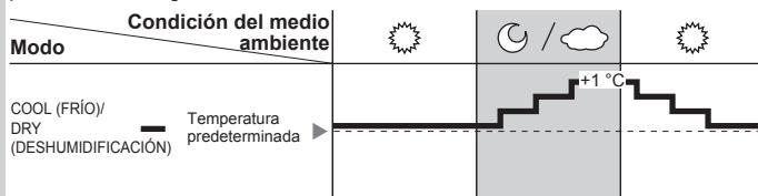
ECONAVI se activa, la unidad mantiene la temperatura ajustada hasta que se detecta una elevada intensidad de luz solar. El sensor de luz solar detecta la intensidad de la luz solar durante cambios de tiempo o de día/noche, y la unidad ajusta la temperatura.
