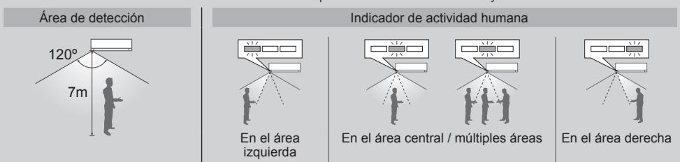
La unidad determina el área de actividad humana durante unos segundos antes de que se actualice el indicador. En función de la actividad del área, la rejilla de dirección de corriente de aire horizontal se ajustará fija en una posición predeterminada u oscilando a la izquierda/derecha de forma periódica.
