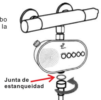
Si su grifería tiene la salida de agua (donde se conecta el tubo flexible de la ducha) en la parte superior, instale la radio tal como muestra la ilustración.
