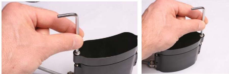
Luego, aprieta los dos tornillos **alternativamente**. Gira cada tornillo 90 grados y luego gira el otro tornillo. Esto previene que la tapa se incline, lo que podría afectar a la impermeabilidad de la junta.
