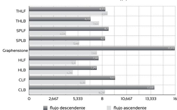
**Absorción por capilaridad (kg/m<sup>2</sup> min<sup>0,5</sup>)**
